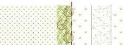
clôture implantée à 40 cm de la limite de lot et plantée en quinconce de part et d'autre
